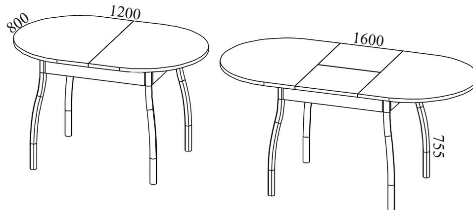
Габаритные размеры: ширина - 1200(1600) мм, высота - 755 мм, глубина - 800 мм.
