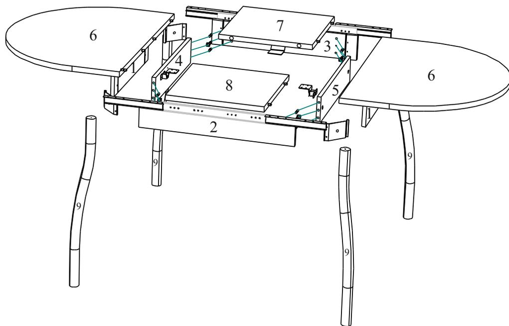
Механизм д/стола крепится к собранной столешнице саморезами 4.0\*16 с прессшайбой.
