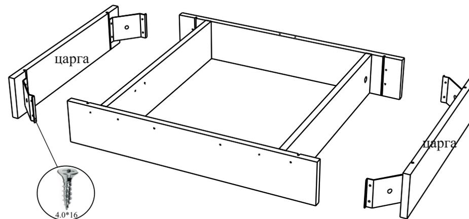
Механизм д/стола крепится к царгам (лев/пр) саморезами 4.0\*16 с пресс-шайбой, механизм "бабочка" - к перегородкам саморезами 4.0\*16. Пандус крепится к торцу царги левой саморезами 4.0\*30.
